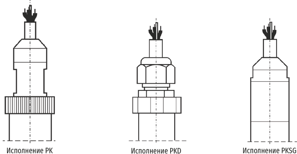
Рисунок 3 - Неразъемные электрические присоединения корпусов исполнений PKD, PKD и PKSG
