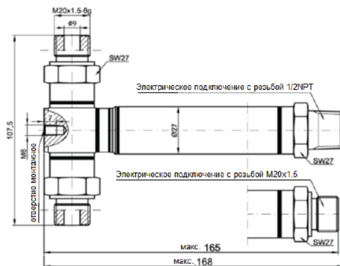
Рисунок В.3 – Внешний вид и габаритные размеры преобразователей PR-28/Exd
