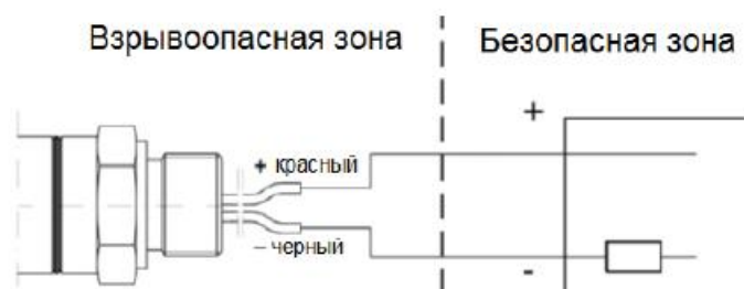
Рисунок Б.4 – Схема электрических подключений преобразователей исполнений PD, PZ, PM12 во взрывобезопасном исполнении
